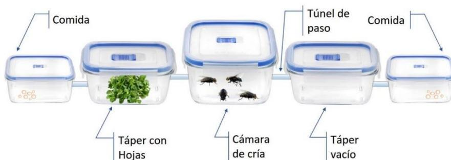
Figura 1. Montaje de contenedores para ensayo de plantas repelentes de insectos.
